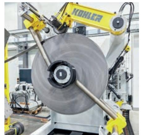
Coilladestuhl und Haspel können mit einer Tragkraft bis zu 35t geliefert werden
