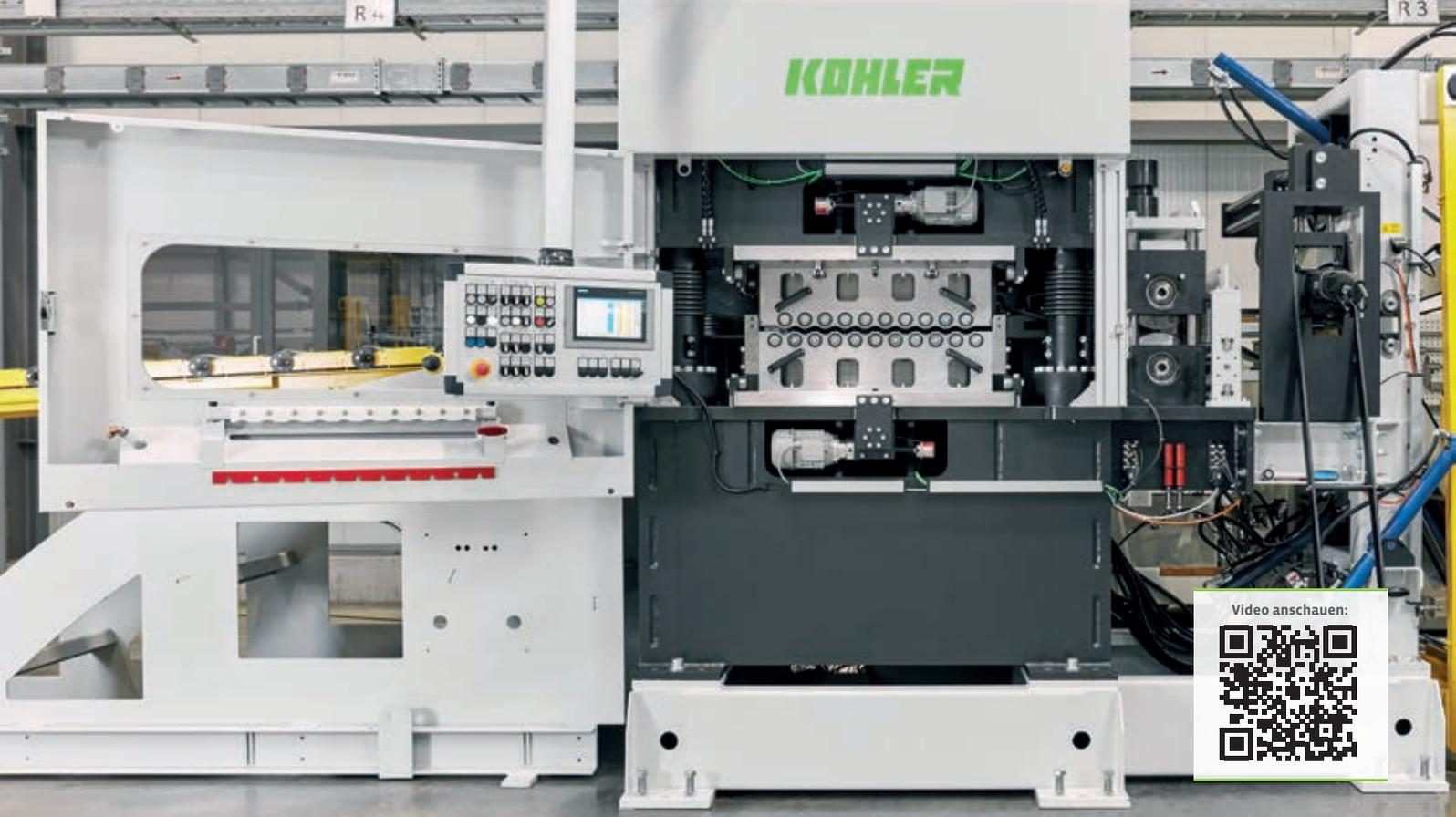
Die Präzisionsrichtmaschine überzeugt mit einer hohen Steifigkeit. Je nach Anwendung können bis zu 21 Richtwalzen mit unterschiedlichen Durchmessern verbaut werden.
